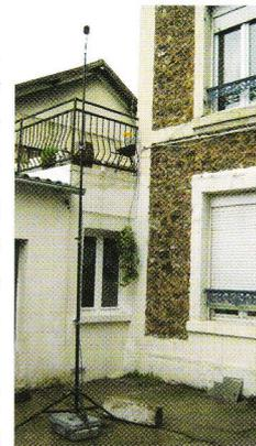
mât de mesure muni d'un microphone
